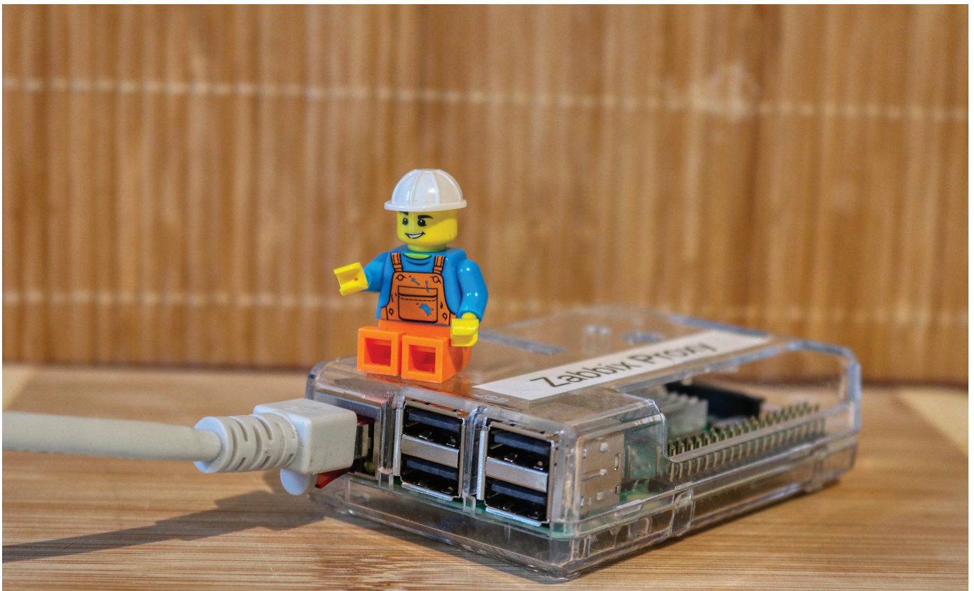
Fig. 2 : Un Raspberry Pi, dans un boîtier, branché à un câble Ethernet avec un Playmobil pour échelle. Grâce à l'étiquette, on devine que celui-ci est utilisé comme un proxy.
