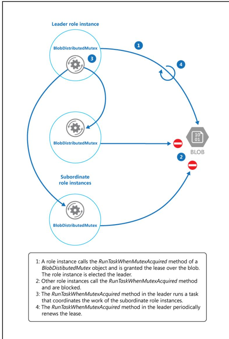
L'exemple de code suivant illustre la manière d'utiliser la classe `BlobDistributedMutex` dans un rôle de travail. Ce code permet d'acquérir le bail d'un objet blob nommé `MyLeaderCoordinatorTask` dans le conteneur du bail du stockage de développement et indique que le code défini dans la méthode `MyLeaderCoordinatorTask` doit être exécuté si l'instance de rôle est élue pour être le leader.
