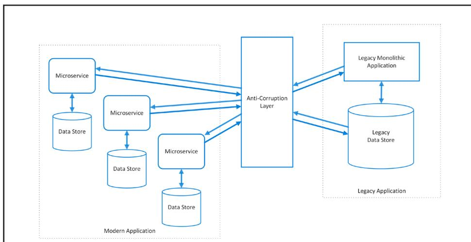
La communication entre l'application moderne et la couche anticorruption utilise toujours l'architecture et le modèle de données de l'application. Les appels entre la couche anticorruption et le système hérité sont conformes aux méthodes ou au modèle de données de ce système. La couche anticorruption contient toute la logique nécessaire pour se déplacer entre les deux systèmes. Cette couche peut être implémentée comme un composant dans l'application ou comme un service indépendant.
