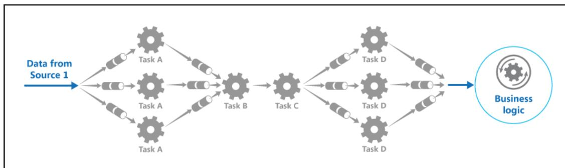
Si l'entrée et la sortie d'un filtre sont structurées comme un flux, il est possible d'effectuer un traitement en parallèle pour chaque filtre. Le premier filtre du pipeline peut démarrer ses travaux et afficher ses résultats qui sont transmis directement au filtre suivant dans la séquence, avant même que le premier filtre n'ait terminé sa tâche.
