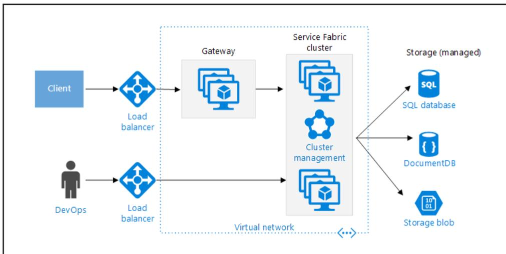
Le cluster Service Fabric est déployé dans un ou plusieurs groupes de machines virtuelles identiques. Vous pouvez inclure plus d'un groupe de machines virtuelles identiques dans le cluster afin de disposer de différents types de machines virtuelles. Une passerelle API est placée devant le cluster Service Fabric, avec un équilibreur de charge externe pour recevoir les requêtes de clients.
