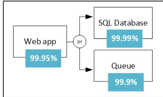
Grâce à cette conception, l'application reste disponible, même si elle ne peut pas se connecter à la base de données. Cependant, elle échoue si la base de données et la file d'attente échouent toutes deux en même temps. Le pourcentage de temps prévu pour un échec simultané est  $0,0001 \times 0,001$ , donc le SLA composite pour ce chemin d'accès combiné est comme suit :
