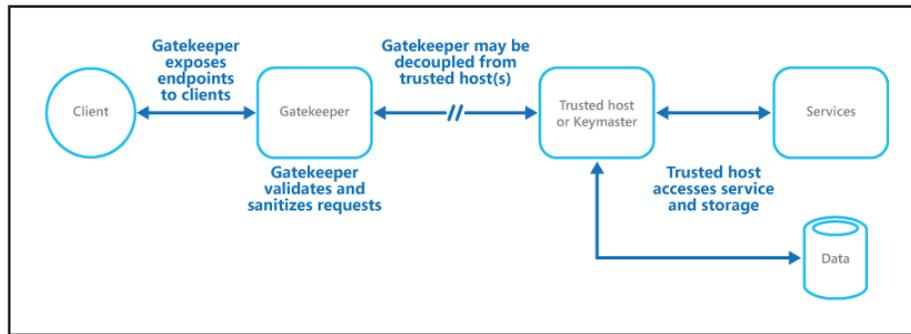
Le patron Gatekeeper (Contrôleur d'accès) peut être utilisé pour protéger simplement le stockage ou peut servir de solution de façade plus complète pour protéger toutes les fonctions de l'application. Les facteurs importants sont les suivants :
