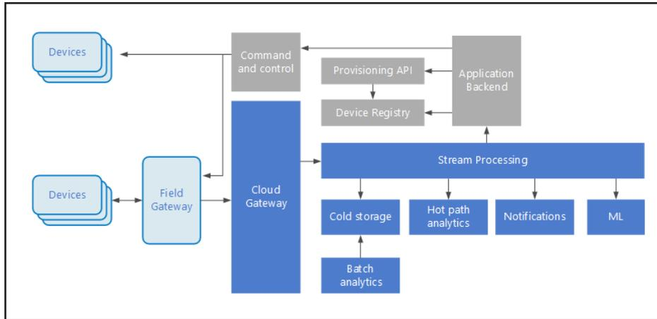
La **passerelle cloud** ingère les événements d'appareils à la limite du cloud à l'aide d'un système de messagerie fiable et à faible latence.
