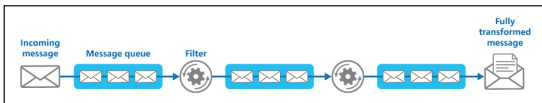
Si vous créez une solution sur Azure, vous pouvez utiliser les files d'attente Service Bus pour profiter d'un système de mise en file d'attente à la fois fiable et évolutif. La classe `ServiceBusPipeFilter` ci-dessous en langage C# illustre la manière d'implémenter un filtre qui reçoit des messages d'une file d'attente, traite ces messages et envoie les résultats à une autre file d'attente.
