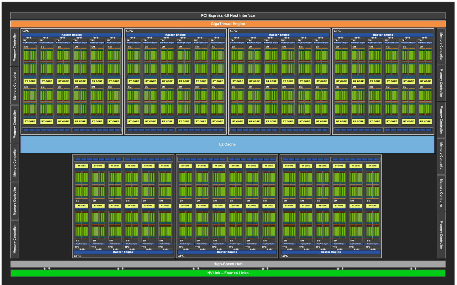
Figure 2. Compléter le GPU GA102 avec 84 blocs SM
