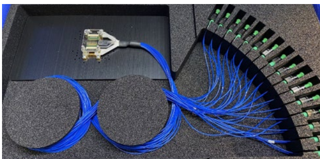
Recombineur optique à base de puce photonique intégrée.
