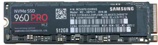
Un SSD Samsung 960 Pro de 512 Go et son connecteur M.2 à droite
