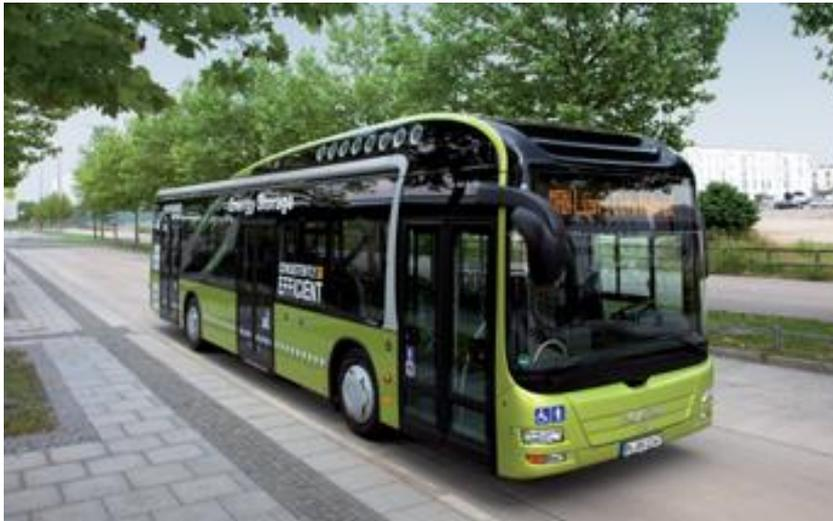
Moteur diesel + superC
