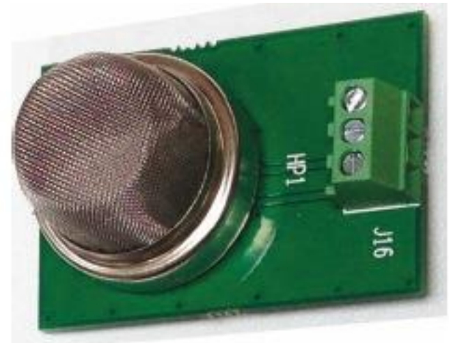
Capteur de Fumée Gaz, CO2, Alcool
