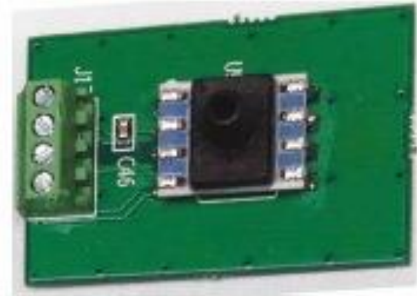
Capteur de pression en Bar de 1 à 10
