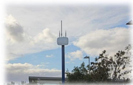
Collecteur radio K901 implanté dans un parking
