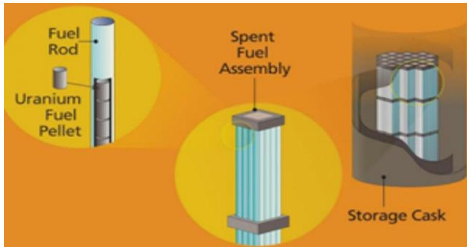
Les conteneurs à sec sont typiquement constitués d'un cylindre métallique scellé pour contenir le combustible utilisé, enfermé dans une coquille extérieure en métal ou en béton pour fournir une protection contre les rayonnements. Dans certains modèles, les conteneurs sont posés verticalement sur un socle en béton ; dans d'autres, ils sont placés horizontalement.
