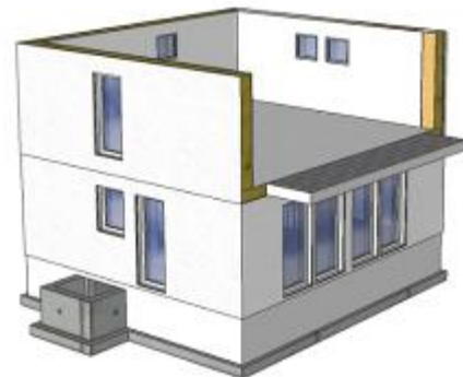
Balcon intégré dans la préfabrication du plancher sur RDC
