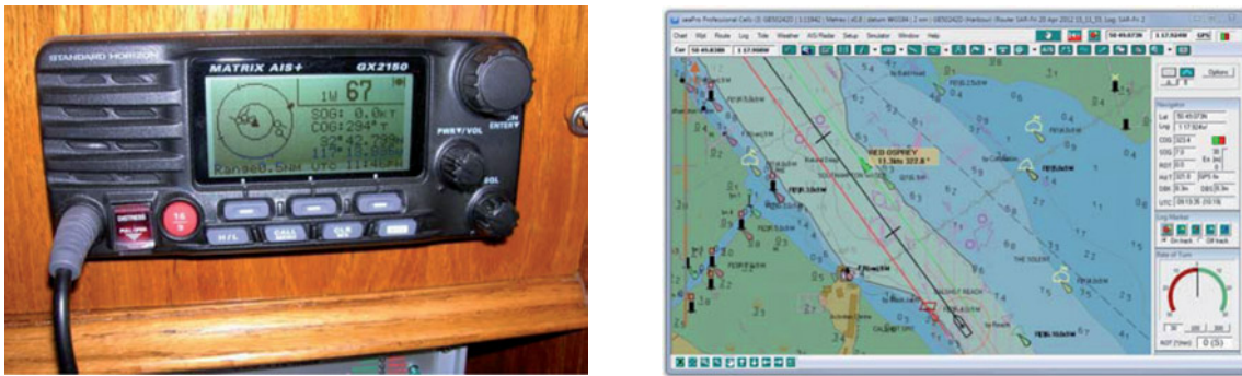
Figure 1 – Récepteur AIS de plaisance (Standard Horizon) et logiciel professionnel (EuroNav)
