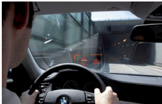
Figure 12 – Le conducteur reçoit une alerte concernant un obstacle caché par l'ombre du tunnel (Crédit BMW)
