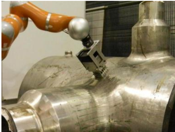
Mise en œuvre d'un capteur multi-éléments flexible ultrasons
