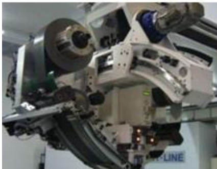
Composites : placement de fibres et nappage (Forest Liné)
