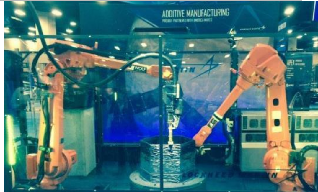
Multi Robot Additive Cluster (MRAC) de Lockheed Martin avec fabrication additive (droite) et soustractive (gauche) simultanées par deux robots (Source : salon DMC 2014)
