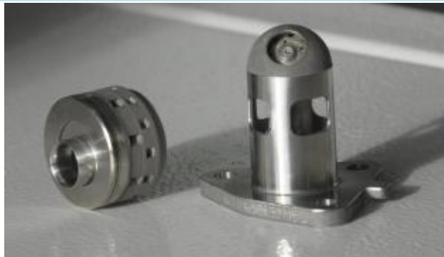
Injecteurs de carburants en superalliages à base de nickel. 12 pièces → 1 pièce (Source: Turboméca)
