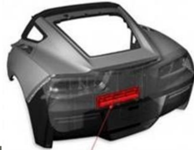
Produire une fermeture de coffre arrière en alliage à mémoire de forme pour supprimer le moteur électrique (Chevrolet Corvette)
