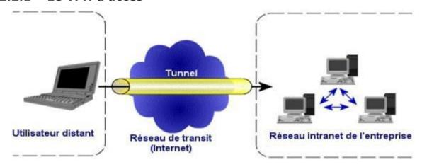
Le VPN d'accès est utilisé pour permettre à des utilisateurs itinérants d'accéder au réseau privé. L'utilisateur se sert d'une connexion Internet pour établir la connexion VPN. Il existe deux cas:
