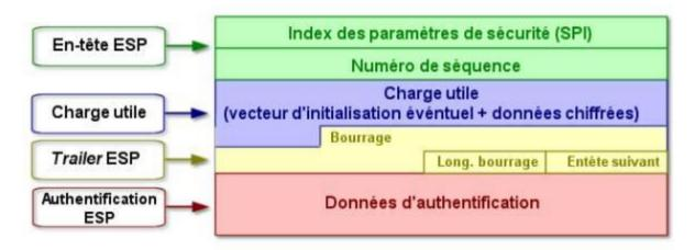
Le champ bourrage peut être nécessaire pour les algorithmes de chiffrement par blocs ou pour aligner le texte chiffré sur une limite de 4 octets.
