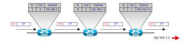
Les routeurs MPLS situés à la périphérie du réseau (Edge Lsr), qui possèdent à la fois des interfaces lp traditionnelles et des interfaces connectées au backbone MPLS, sont chargés d'imposer ou de retirer les labels des paquets lp qui les traversent. Les routeurs d'entrée, qui imposent les labels, sont appelés Ingress Lsr, tandis que les routeurs de sortie, qui retirent les labels, sont appelés Egress Lsr.
