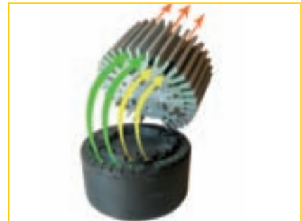
Figure 29 : Refroidisseur acoustique « Synjet » - Source : Nuventix
