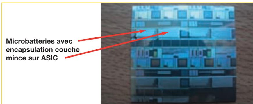
Figure 4 : Prototype de micro-batterie déposée sur tranche de silicium
