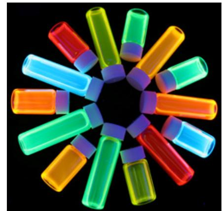
Solutions de boîtes quantiques de divers diamètres constituées de nanocristaux de CdSe/ CdTe
