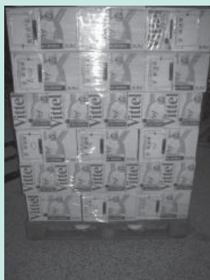
DAG Colis posés sur des colis contenant du liquide
