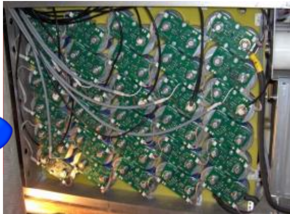
Photo de la face instrumentée d'un module de supercondensateur
