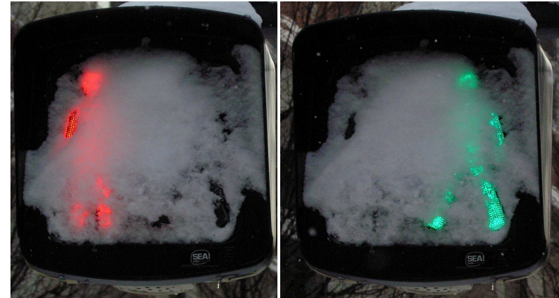
L'absence de rayonnement IR permet à la neige de subsister sur les feux tricolores !
